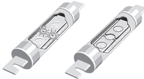
Fusible durante la falla
